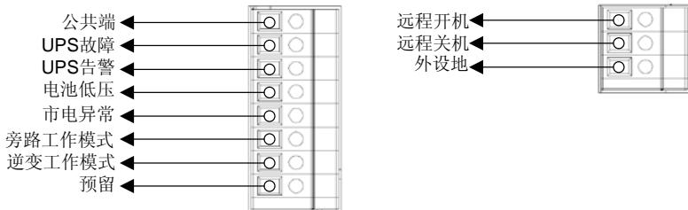
由于机器提供的输出干节点信号为短路和开路两种状态，不提供高低电平信号，因此客户使用需要外接电源。输入干节点不用额外使用电源来驱动，将对应信号与地引脚进行短路或开路即可。
