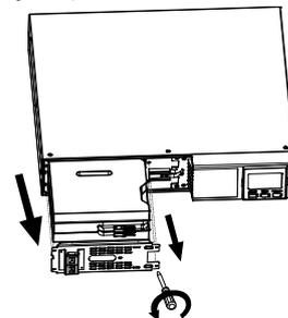
先将电池档板上的螺丝取下, 移除电池档板后, 将电池包拉出。
