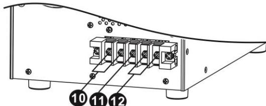
图 3: 6K(L)/10K(L) 输入输出端子
